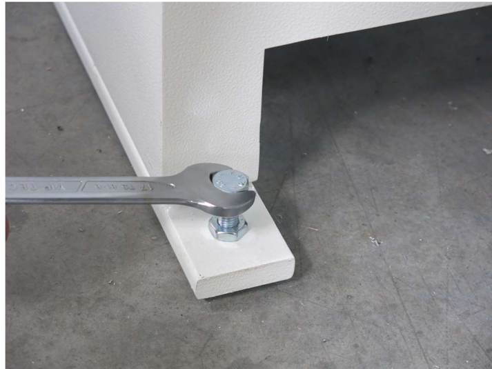
Рисунок 6.5: Балансировка станка с помощью установочных болтов
